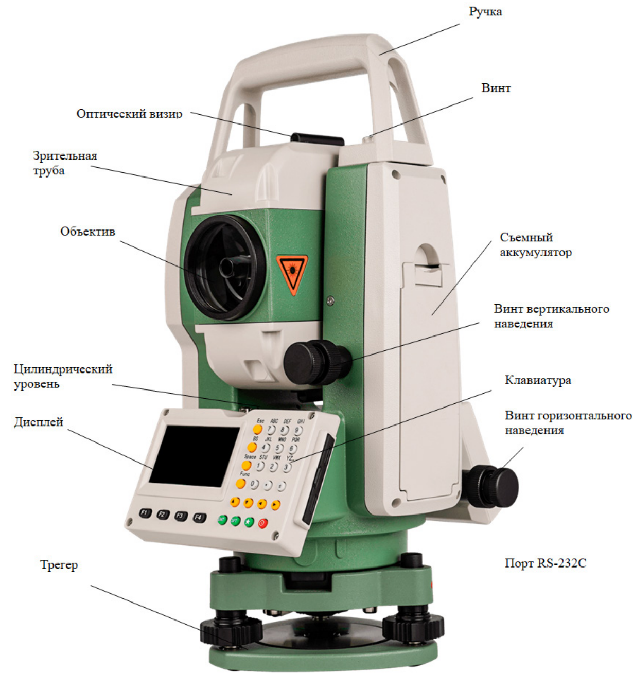
Рисунок 3 - Основные элементы тахеометра RTS102N
